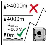
**WICHTIG!** Der Wechselrichter darf über einer Seehöhe von 4000 m nicht mehr montiert und betrieben werden.
