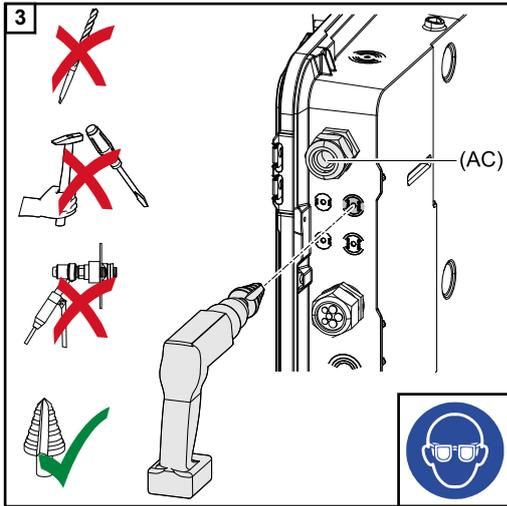
Die optionale Kabelführung mit einem Stufenbohrer aufbohren.
