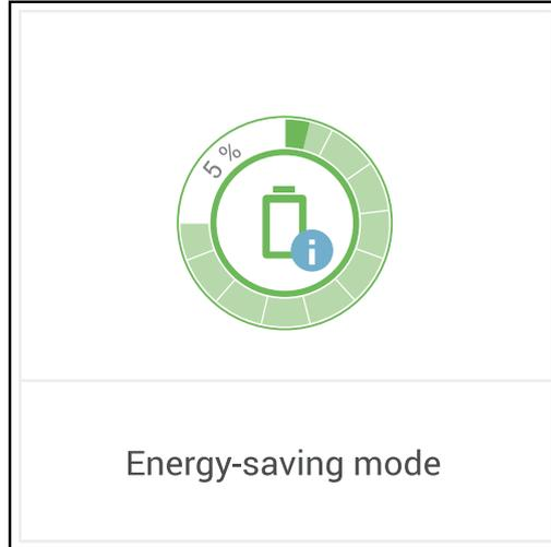
Der Energiesparmodus wird auf der Webseite des Wechselrichters und im Solar.web durch ein „i“ neben dem Batterie-Symbol in der Anlagenübersicht dargestellt.
