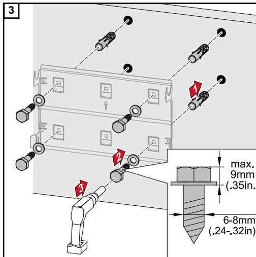
**Montagehalterung auf einem Mast oder Träger montieren**
