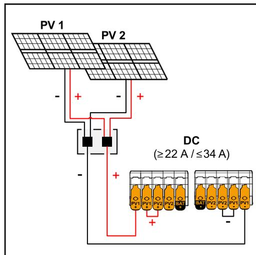
Kombinierte Solarmodulstränge mit Summenstrom ( $I_{dcmax}$ ) größer/gleich 22 A
