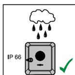
Der Wechselrichter ist für die Montage im Außenbereich geeignet.
