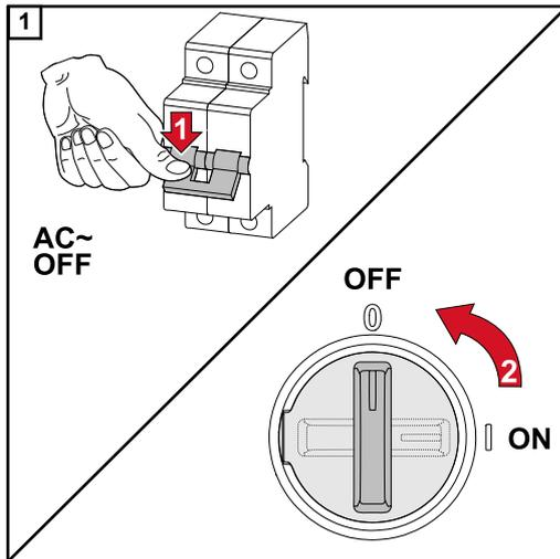
Den Wechselrichter stromlos schalten und die angegebene Entladezeit der Kondensatoren sowie den Stillstand des Lüfters abwarten.
