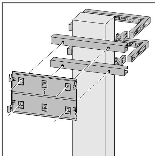
Bei der Montage des Wechselrichters auf einem Mast oder Träger empfiehlt Fronius das Befestigungsset „Pole clamp“ (Bestell-Nr. SZ 2584.000) der Firma Rittal GmbH.
