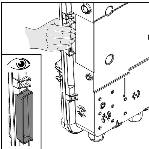
Seitlich am Wechselrichter befinden sich integrierte Haltegriffe, die das Anheben/Einhängen erleichtern.
