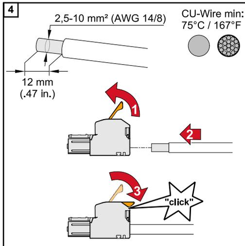
Von den Einzelleitern 12 mm abisolieren. Kabel-Querschnitt gemäß der Angaben in **Zulässige Kabel** ab Seite **56** wählen. Den Betätigungshebel der Anschlussklemme durch Anheben öffnen und den abisolierten Einzelleiter in den vorgesehenen Steckplatz bis zum Anschlag in die Anschlussklemme stecken. Danach den Betätigungshebel bis zum Einrasten schließen.
