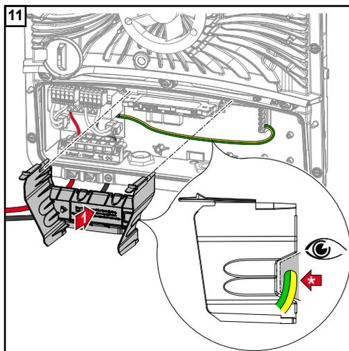
Abtrennung des Anschlussbereichs wieder einsetzen.
