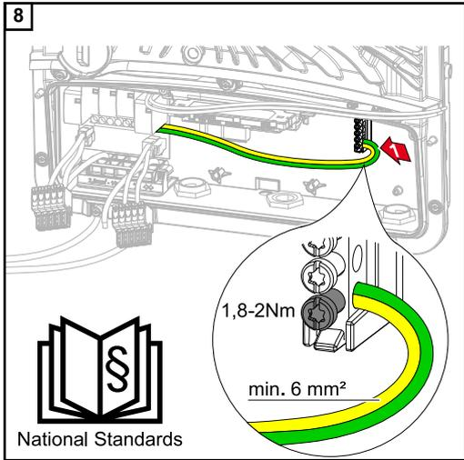
Den Schutzleiter mit einem Kabel-Querschnitt von min. 6 mm<sup>2</sup> am ersten Eingang von unten an der Erdungselektroden-Klemme mit einem Schraubendreher (TX20) und einem Drehmoment von 1,8 - 2 Nm befestigen.
