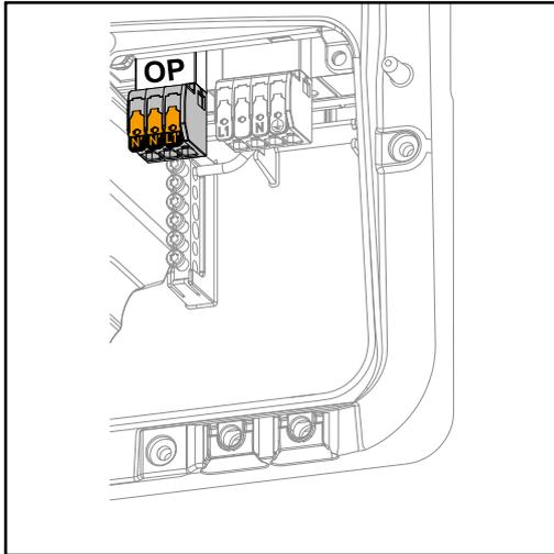
Mit dem PV Point können an der Opportunity Power (OP) Anschlussklemme bei Ausfall des öffentlichen Netzes elektrische Geräte bis zu einer maximalen Leistung von 3 kW versorgt werden, wenn dazu genügend Leistung von den Solarmodulen oder einer optionalen Batterie zur Verfügung steht. An der OP-Anschlussklemme liegt im netzgekoppelten Betrieb keine Spannung an, daher werden in diesem Betrieb die angeschlossenen Lasten nicht versorgt.
