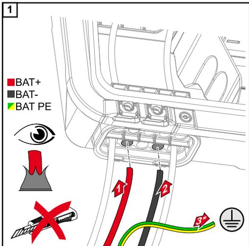
Die BAT-Kabel mit der Hand durch die DC-Durchführungen stoßen.
