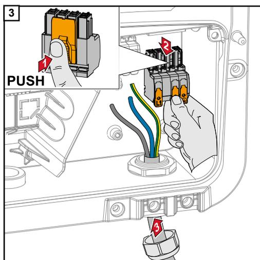
Das Netzkabel von unten durch die an der rechten Seite befindliche Zugentlastung durchführen.
