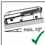
Der Wechselrichter ist für die Montage auf einer schrägen Fläche (min. 10° Neigung zur Unterseite) geeignet.
