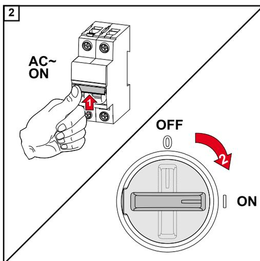
Den Leitungs-Schutzschalter einschalten. DC-Trenner in die Schalterstellung „Ein“ stellen.
