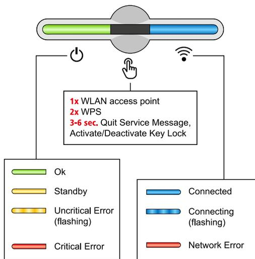
Über die Betriebs-LED wird der Zustand des Wechselrichters angezeigt. Bei Störungen sind die einzelnen Schritte im Fronius Solar.web live App durchzuführen.
