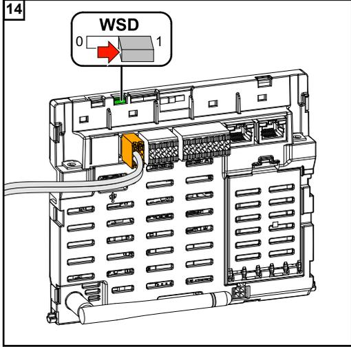
Kontrollieren ob sich der WSD-Switch auf Position 1 befindet, gegebenenfalls einstellen (Werkseinstellung: Position 1).
