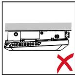
Den Wechselrichter nicht an der Decke montieren.
