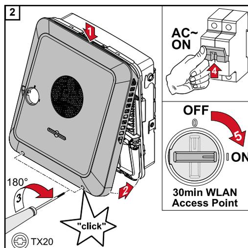
Den Gehäusedeckel von oben am Wechselrichter einhängen.
