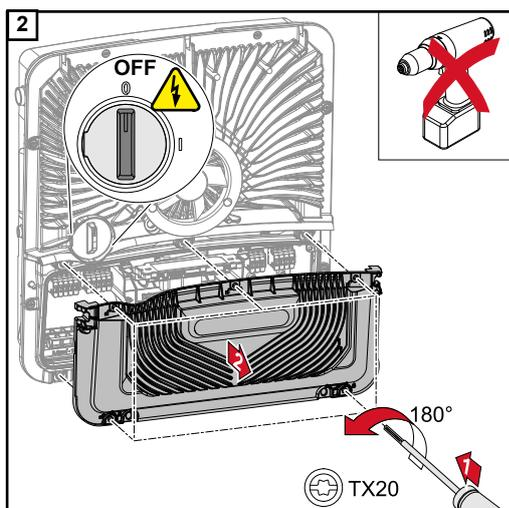
Sicherstellen, dass sich der DC-Trenner in der Schalterstellung „Aus“ befindet. Die 5 Schrauben der Abdeckung des Anschlussbereiches mit einem Schraubendreher (TX20) und einer 180°-Drehung nach links lösen. Die Abdeckung des Anschlussbereiches vom Gerät nehmen.
