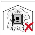
Grundsätzlich ist der Wechselrichter staubdicht (IP 66) ausgeführt. In Bereichen mit starker Staubansammlung können sich Staubablagerungen auf den Kühlflächen ansammeln und somit die thermische Leistungsfähigkeit beeinträchtigen. In diesem Fall ist eine regelmäßige Reinigung erforderlich siehe Kapitel **Betrieb in Umgebungen mit starker Staubentwicklung** auf Seite 133. Eine Montage in Räumen und Umgebungen mit starker Staubentwicklung ist daher nicht zu empfehlen.
