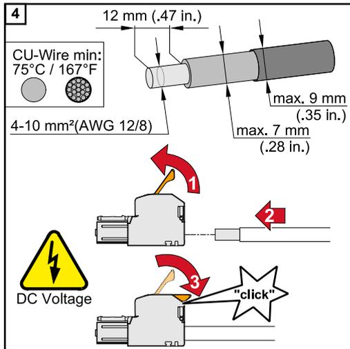
Kabel-Querschnitt gemäß der Angaben in **Zulässige Kabel** ab Seite **56** wählen. Von den Einzelleitern 12 mm abisolieren. Den Betätigungshebel der Anschlussklemme durch Anheben öffnen und den abisolierten Einzelleiter in den jeweils vorgesehenen Steckplatz bis zum Anschlag in die Anschlussklemme stecken. Danach den Betätigungshebel bis zum Einrasten schließen.
