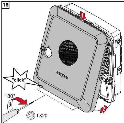
Den Gehäusedeckel von oben am Wechselrichter einhängen.
