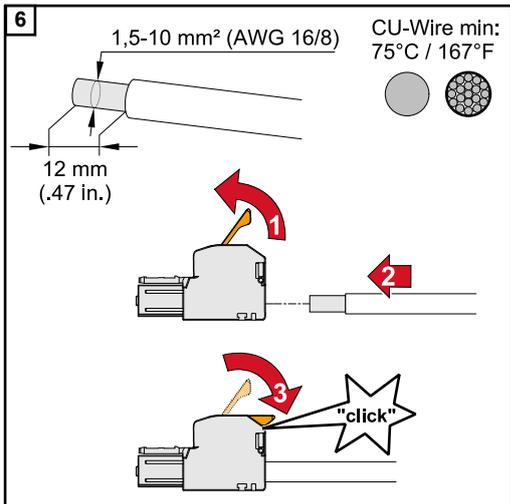
Von den Einzelleitern 12 mm abisolieren. Der Kabel-Querschnitt muss zwischen 1,5 mm<sup>2</sup> und 10 mm<sup>2</sup> betragen. Den Betätigungshebel der Anschlussklemme durch Anheben öffnen und den abisolierten Einzelleiter in den vorgesehenen Steckplatz bis zum Anschlag in die Anschlussklemme stecken. Danach den Betätigungshebel bis zum Einrasten schließen.
