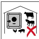
Den Wechselrichter nicht montieren in:
