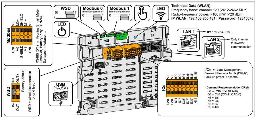
Push-in Anschlussklemme für die Installation von Modbus 0, Modbus 1, 12 V und GND (Ground).
