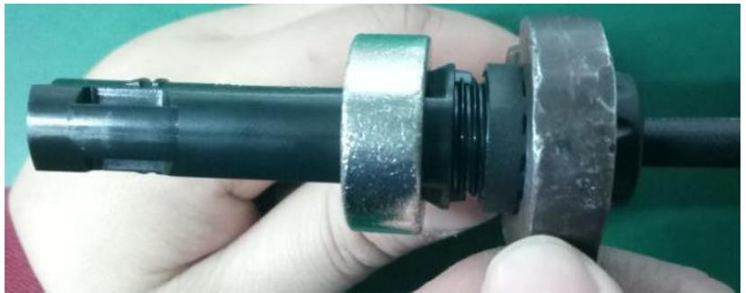
5.把工具 1 固定于正极塑件，使用工具 2 顺时针转动螺帽，把螺帽拧紧，力矩为 2.0-3.0Nm（根据线缆类型，紧固力矩有所不同）。
