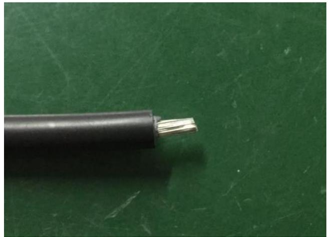
2. 先将插针（或插孔）U形处放在压线钳钳口处，再将剥皮后的电缆线放在插针（或插孔）U形上，放到底，将线皮贴紧U形开口处，再用压接钳压紧直到压接钳可自由松开(或用台式双用精密压力机冲压)，连接力 $\geq 310\text{N}$ 。
