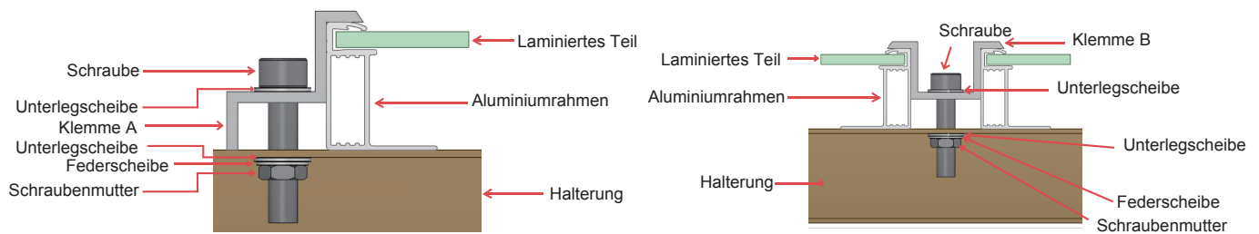
Abbildung 5 Klemminstallation des Monofacial-Moduls
