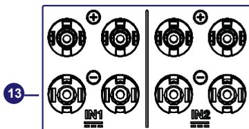
Die Eingangsanschlüsse sind in zwei (2) Gruppen untergliedert (eine Gruppe für jeden MPPT). Für jeden MPPT sind zwei (2) Steckverbinderpaare verfügbar.
