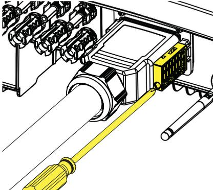
⚠ **ACHTUNG** – Der AC-Schnellverbinder darf keinen Zugkräften ausgesetzt sein (Beispiele: verbinden Sie keine Lasten mit dem AC-Kabel, lassen Sie überstehende Kabelwicklungen nicht herumhängen etc.).
