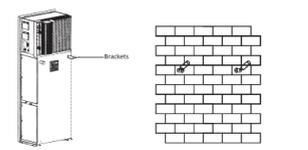
Bohren Sie die Löcher an den Markierungen mit einem Bohrer mit einem Durchmesser von 6 mm. Setzen Sie die Dehnschrauben in die Löcher ein.
