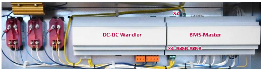
Abbildung 7: Anordnung BMS-Master, DC-DC Wandler, Relais und Vorladewiderstand
