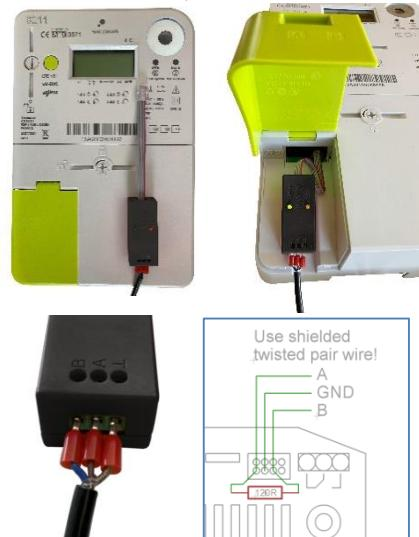
⚠ Gebruik afgeschermde twisted pair kabel!
