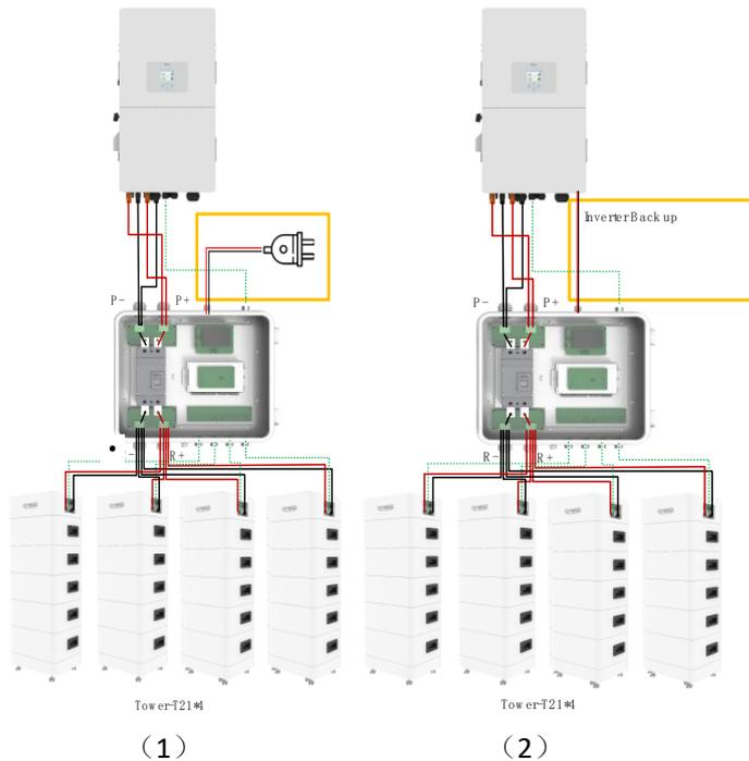
Im Off-Grid (Netzausfall) Modus: Der „Power AC IN“ Anschluss muss zuerst an das USV-Gerät und dann an die Backup Seite des Wechselrichters angeschlossen werden,
