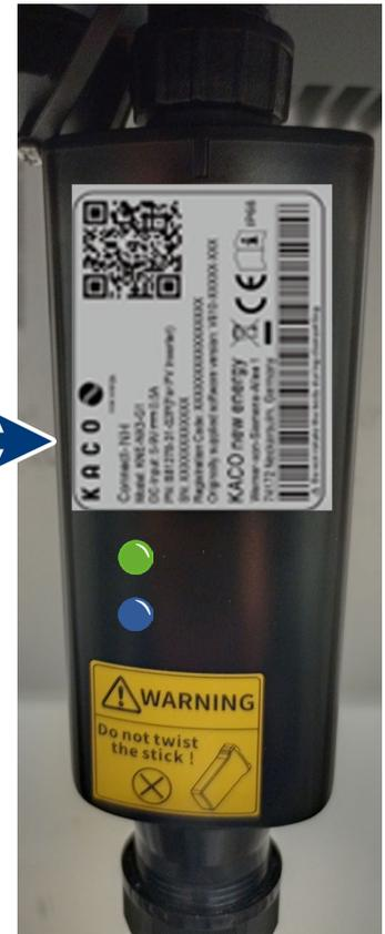
Abb. 74. Verbindung hergestellt – blaue LED blinkt.
