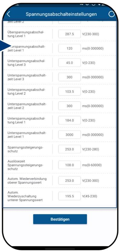
Abb. 139. Spannungsbereich und Abschaltzeiten festlegen
