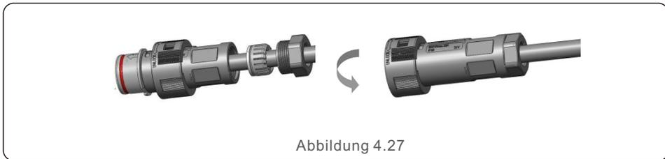
6. Die gleiche Installation für beide Stecker und Buchsen am Kabelende.
