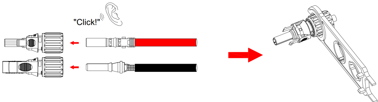
Abbildung 4.6-3 Anschließen der positiven und negativen Anschlüsse
