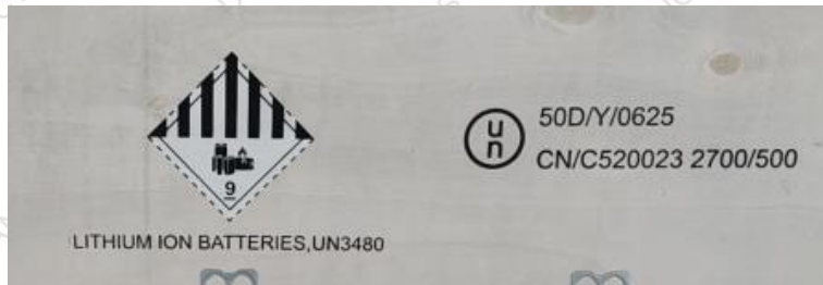
UN 号, 包装等级, 9A 号标签 UN NO., packing group, 9A label
